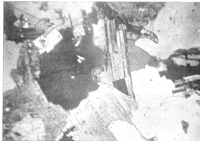
Fig. 2.—Muestra núm. 2. Mérida. Km. 12 del f. c. de Cáceres a Mérida. Granito de grano grueso porfiróide. Nicles cruzados. \times 35 . Fot. R. de Luna
